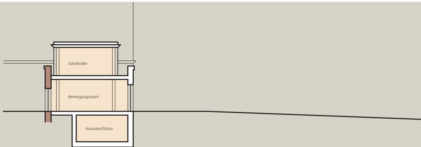
Querschnitt C-C 1:200 - Neubau
